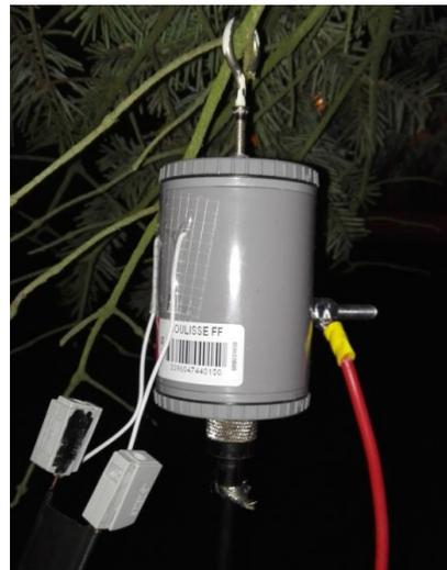
Le balun 1 :1 permet d'adapter l'impédance pour la liaison avec le câble coaxial mais aussi de passer d'une antenne symétrique à une liaison coaxiale asymétrique.
