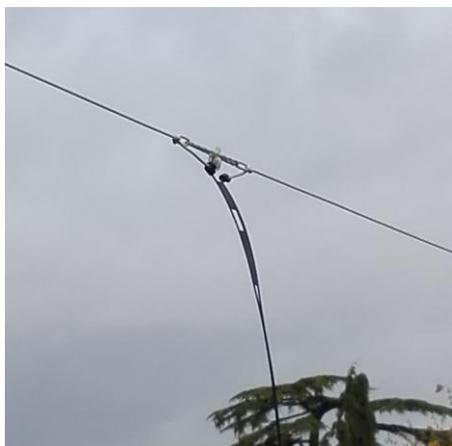
Une antenne multi bande 80/40/20 m pour un bon compromis de réception de 3,5 Mhz à 30 Mhz (optimisée pour 14,1 Mhz)
